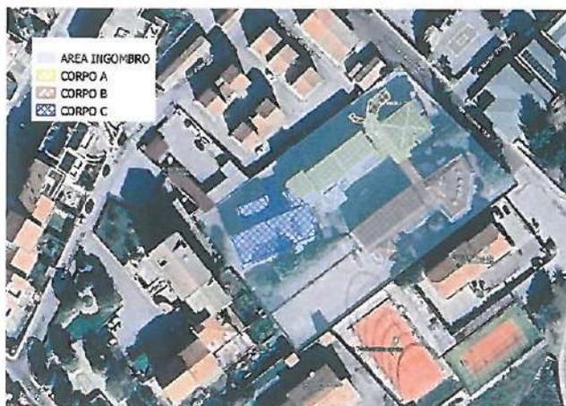
La struttura occupa una superficie di circa 2.900 m<sup>2</sup> ed un volume di 10.410 m<sup>3</sup>, l'epoca della realizzazione risale alla fine degli anni 70 e presenta una struttura intelaiata con tamponamenti in blocchi di cemento forati e solai in latero cemento, le tramezzature interne sono realizzate con tramezzature in laterizio.
